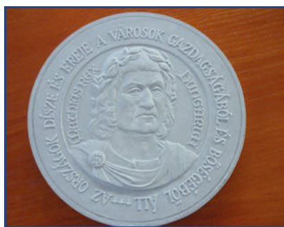
A Mátyás király emlékérem gipszmintája, melyről a verőtőke készül Szegeden
