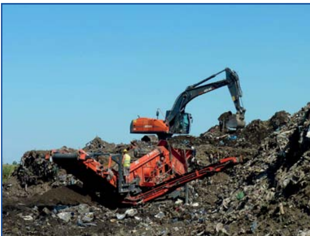
A válogatás egyik munkafolyamata: a rakodógép a szalagra teszi a lenakott hulladékot, melyet a válogató szalag szétválaszt hulladék és föld frakcióra
