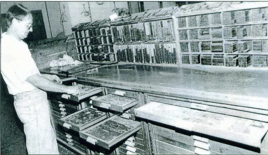
A betűszekrény. A felső rekeszokban ún. vakanyagok vannak, amelyekkel az újság fehéren maradt részeit töltötték ki.
